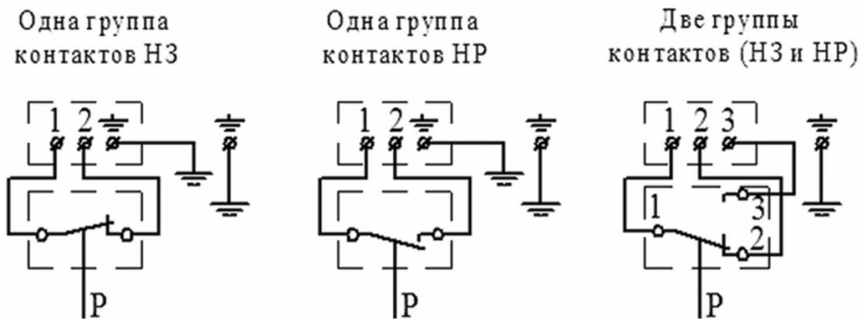
Рисунок 3. Схема электрическая соединений реле давления РК-302Д
